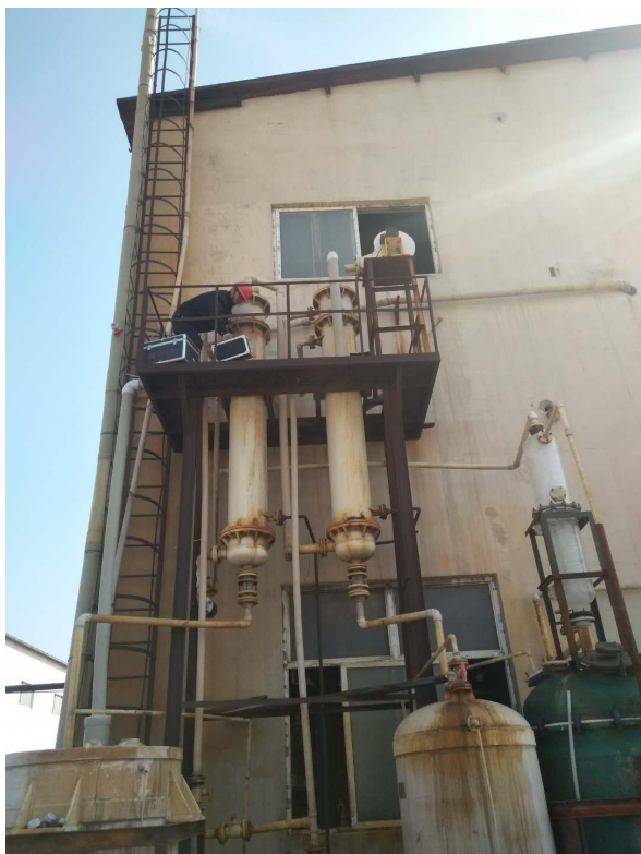
图4-1 羟基硅油生产线尾气吸收装置
